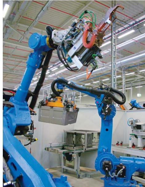
Die Entnahme aus der Vorrichtung sowie das Punktschweißen erfolgt mit Industrie-robotern vom Typ MOTOMAN-ES165N.
