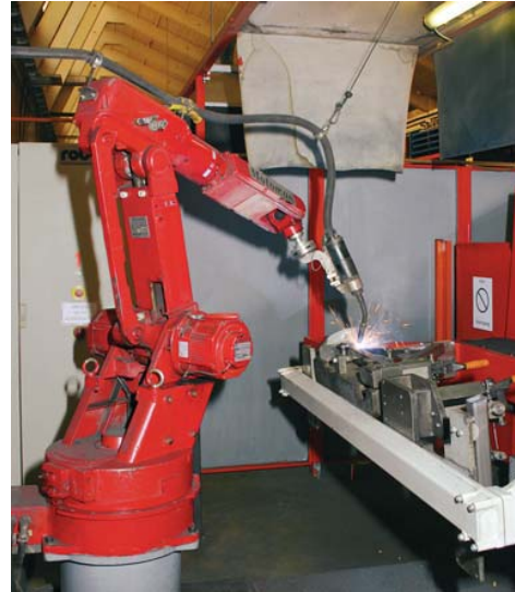
Die erste Roboter-Schweißzelle von MOTOMAN® wurde 1991 in Betrieb genommen und läuft seitdem problemlos im 3-Schichtbetrieb.
