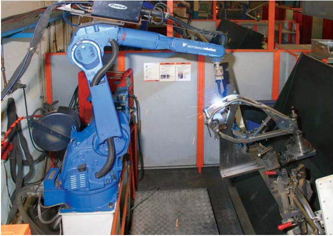
Die Motorradrahmen bestehen im Schnitt aus ca. 60 Einzelteilen, die in verschiedenen Vorrichtungen zusammen geschweißt werden.
